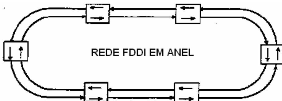
**Fig 2.10** Uma rede PDDI com fibras óticas fazendo a conexão de seis computadores. As setas indicam a direção do tráfego nas fibras e nos computadores conectados entre si.
